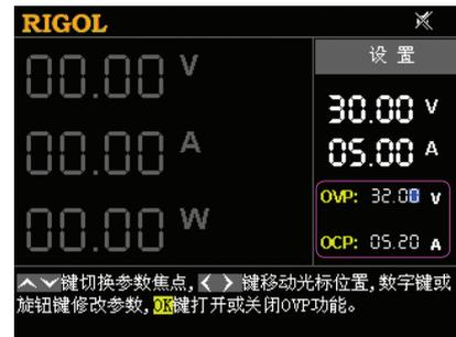
用户可以设置过压和过流保护的限值，当发生过压或过流时，电源将自动关闭输出并给出提示消息。
