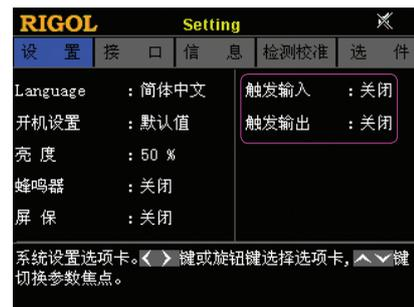
当多台电源串联或并联时，使用外触发功能可使多台电源同步输出。
