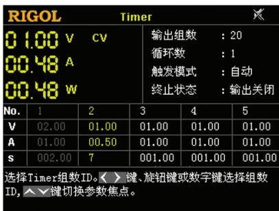
定时输出打开时，可以按照预先设置的定时器参数配置不同时间段的电压和电流值，为负载提供变化的电压和/或电流输出。
