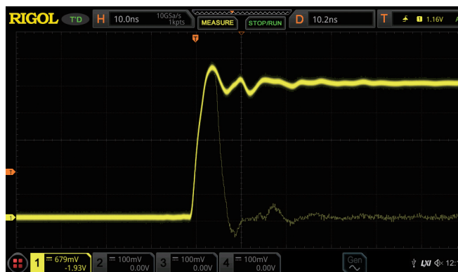
高刷新率模式下捕获偶发异常信号
