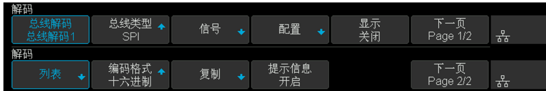
图 65 SPI 解码设置菜单
