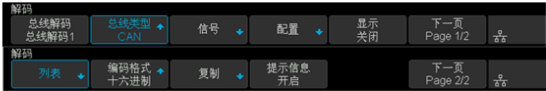
图 77 CAN 解码设置菜单
