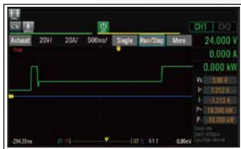
示波, 显示实时电压及电流曲线
