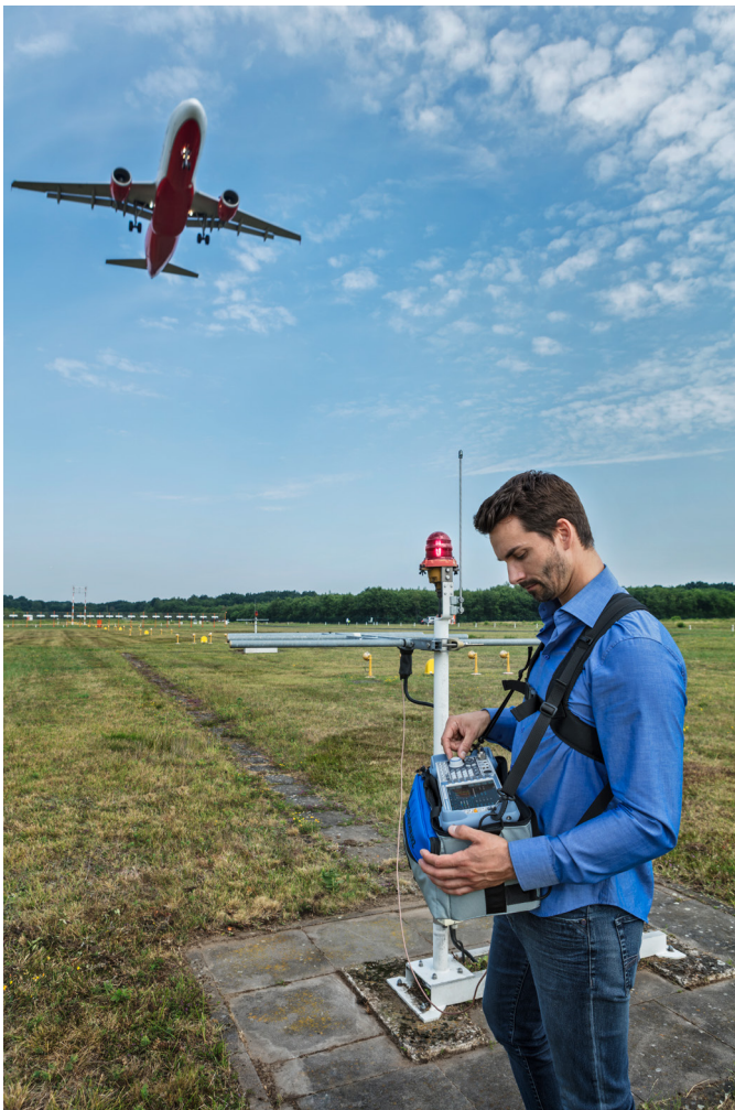
ILS measurements on an ILS monitoring antenna
