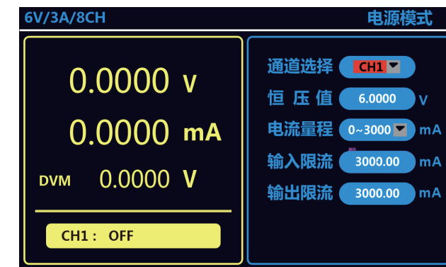
▲超高电流精度和分辨率可直接测量静态电流
