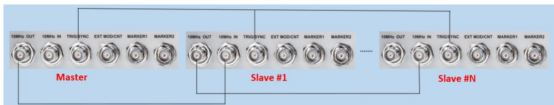
图 17.1 多设备同步的连线示意图
