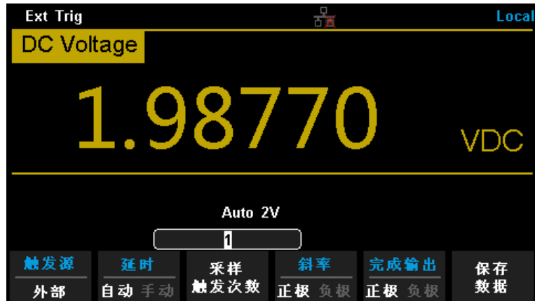
图 2-48 触发源为单次触发的采样
