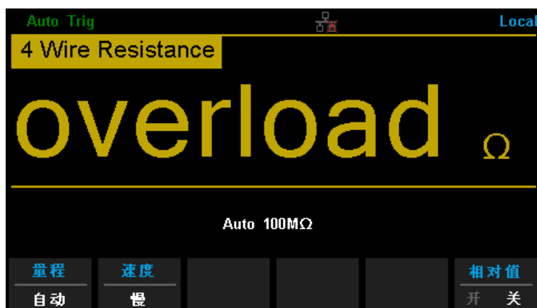
图 2-15 四线电阻测量界面
