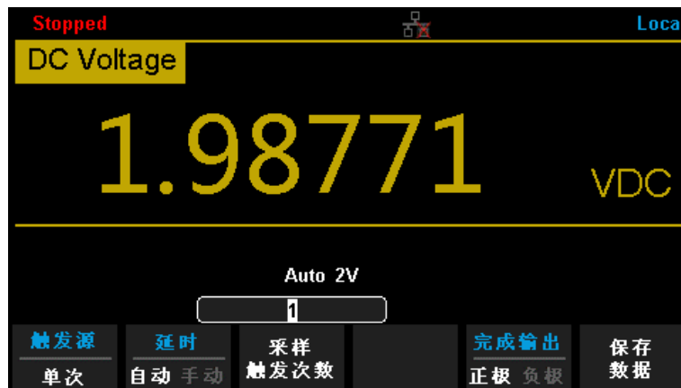
图 2-47 触发源为单次触发的采样
