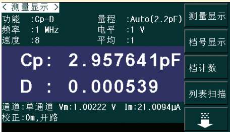
陶瓷电容的高速高精度测试
