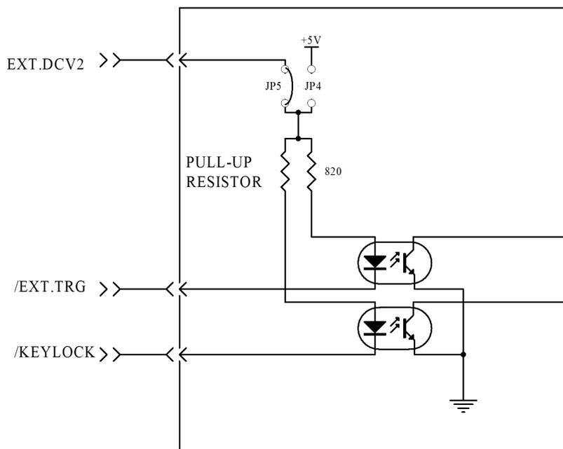
图 5-11 控制信号输入电路
