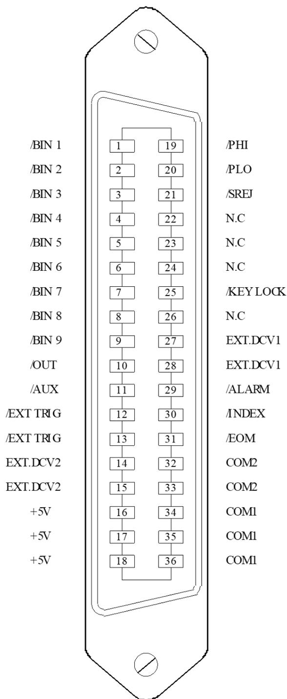
图 5-5 HANDLER 连接接口管脚定义
