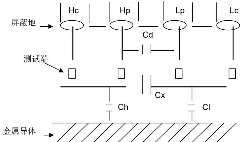
图 6-1 杂散电容的影响示意图
