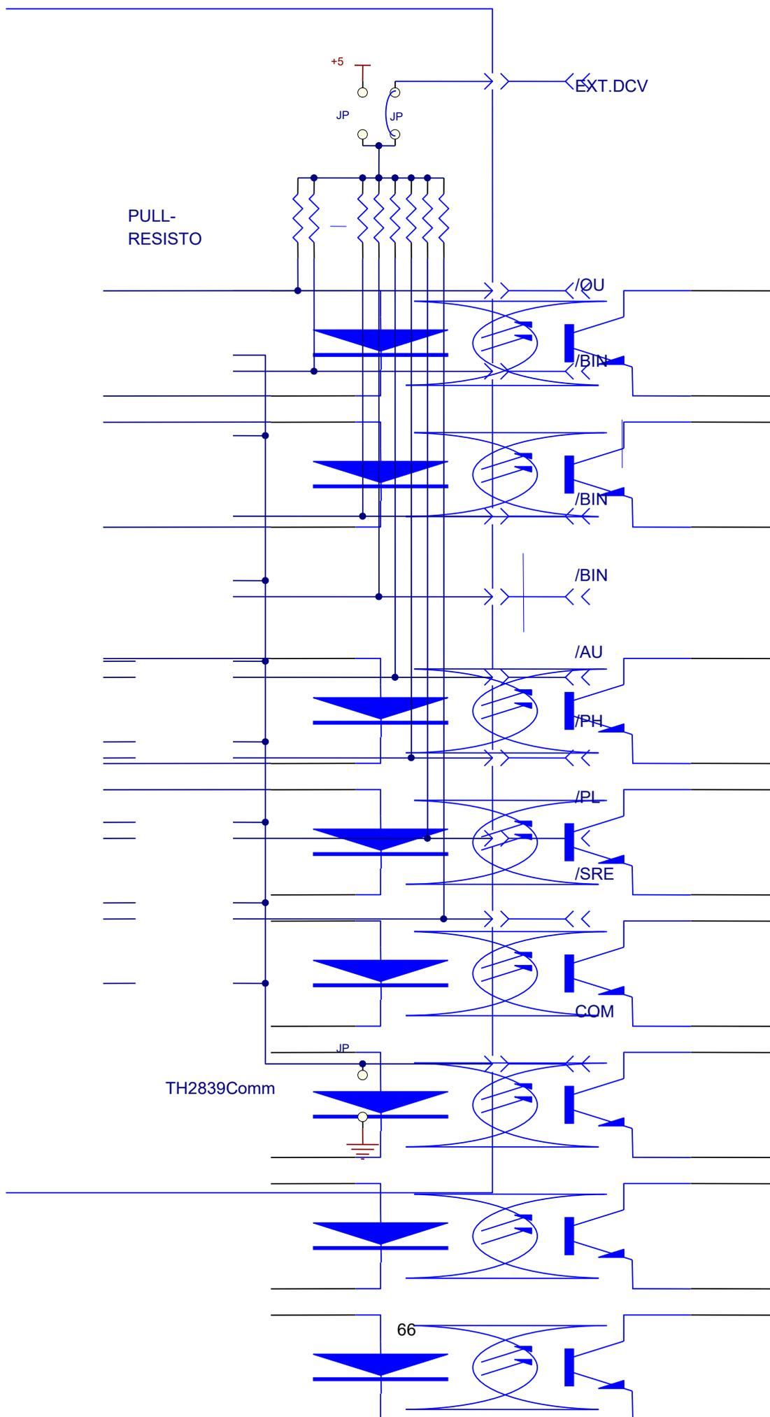
图 5-9 比较结果信号输出电路
