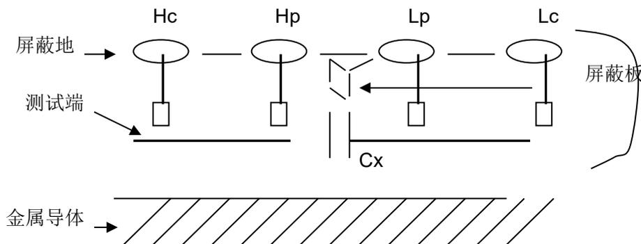
图 6-2 消除杂散电容影响方法示意图
