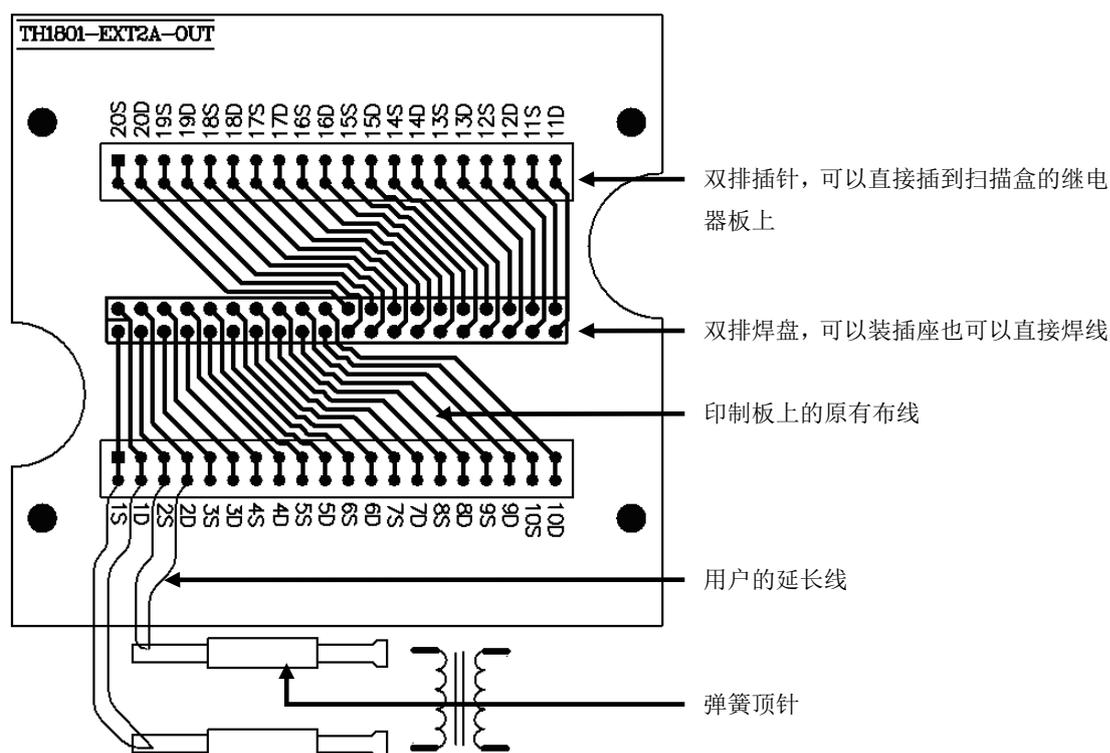
4 线测试的原理就是驱动端 (DRIVE) 和感应端 (SENSE) 测试线要分开走，图中 1 D 代表 1 脚的驱动端，1 S 代表 1 脚的感应端，依次类推。
