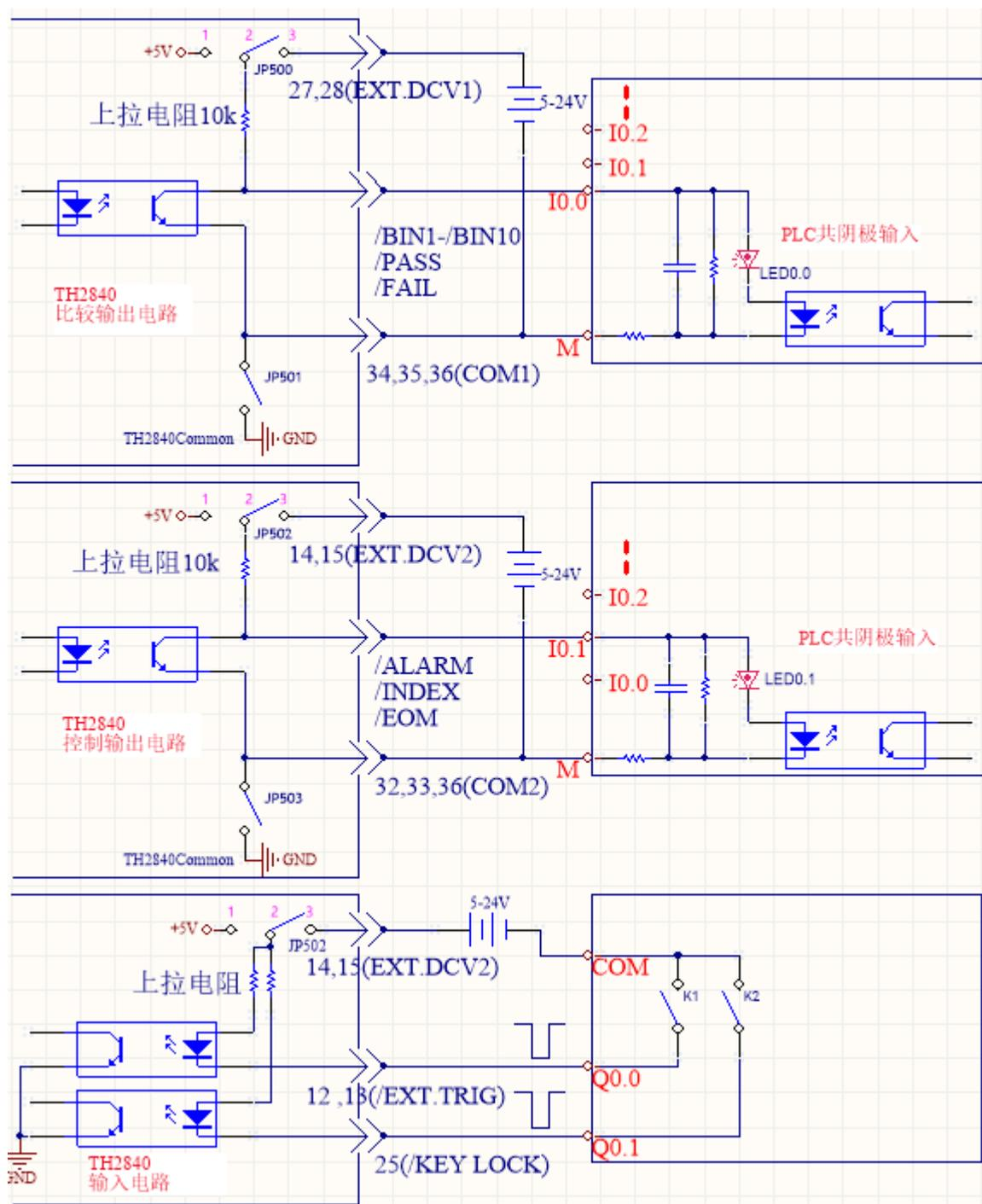
图 10-8 与输入电路为共阴极的 PLC 接线图
