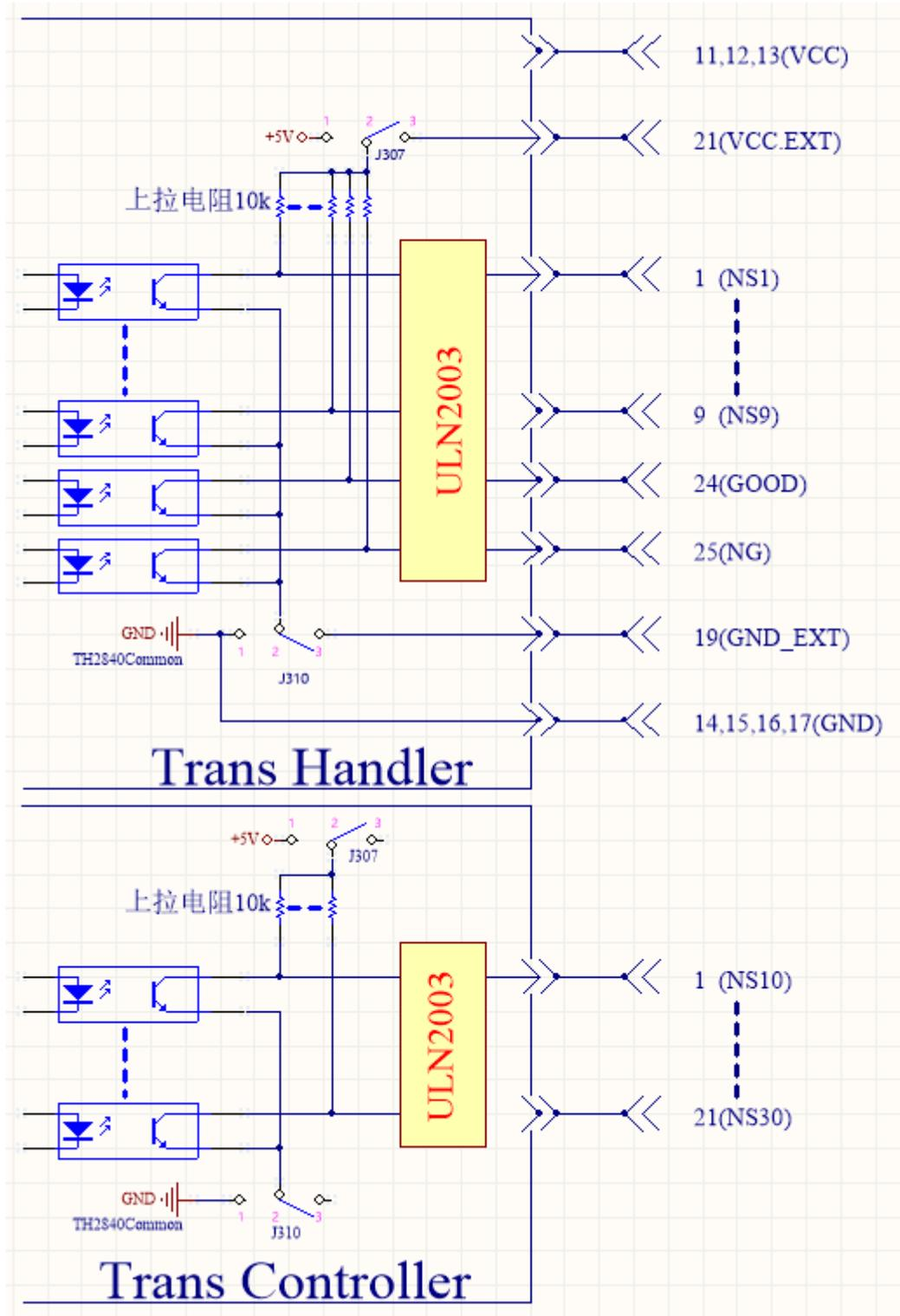
图 10-13 比较结果信号输出电路
