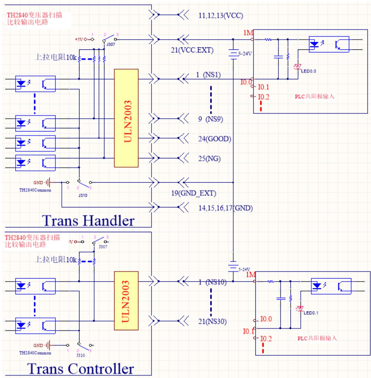
图 10-16 与输入电路为共阳极的 PLC 接线图
