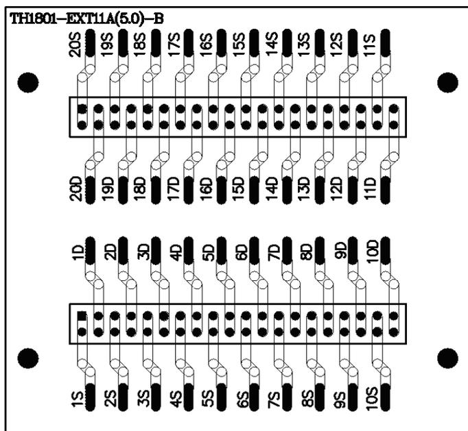
4 线测试的原理就是驱动端 (DRIVE) 和感应端 (SENSE) 测试线要分开走，图中 1 D 代表 1 脚的驱动端，1 S 代表 1 脚的感应端，依次类推。
