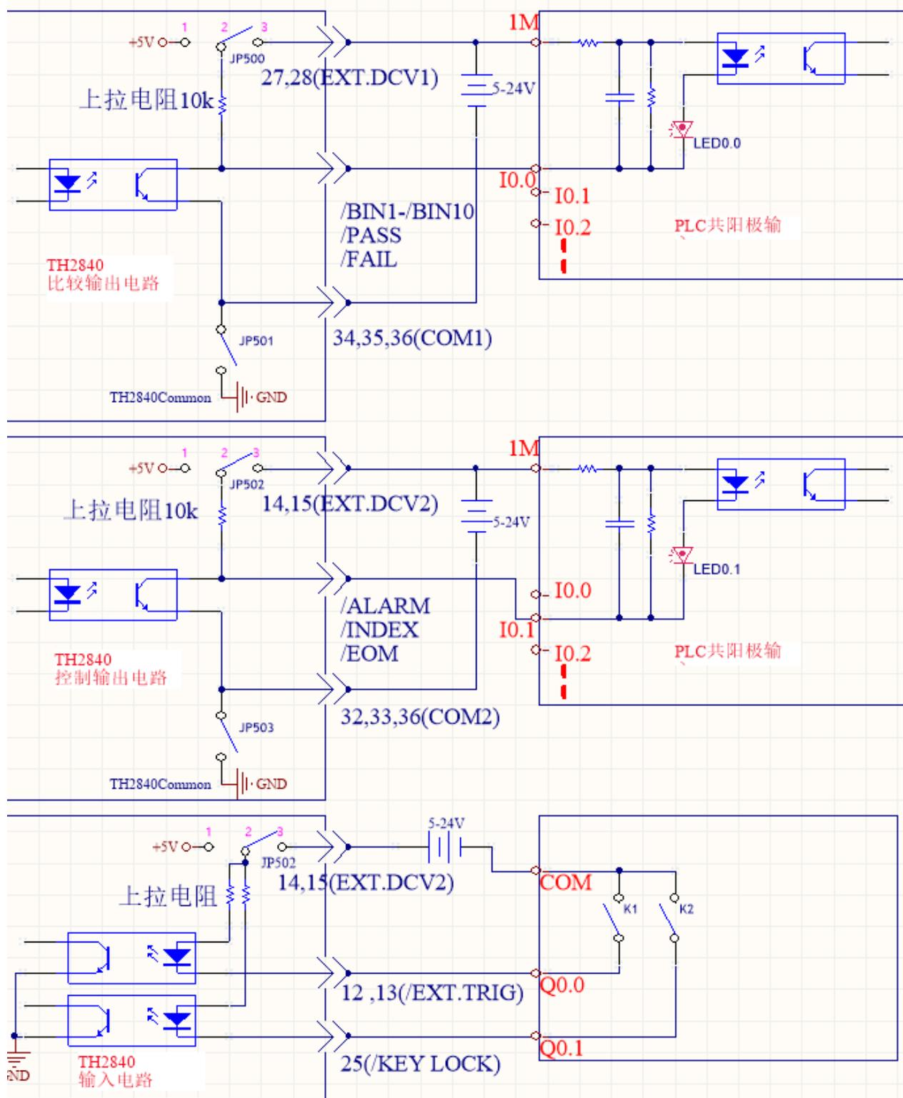
图 10-7 与输入电路为共阳极的 PLC 接线图
