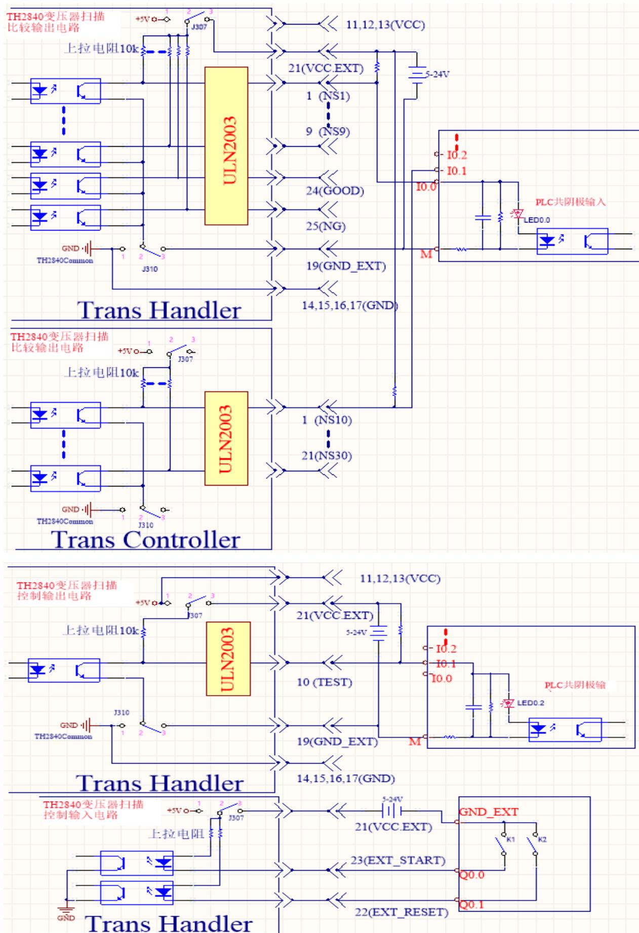
图 10-17 与输入电路为共阴极的 PLC 接线图
