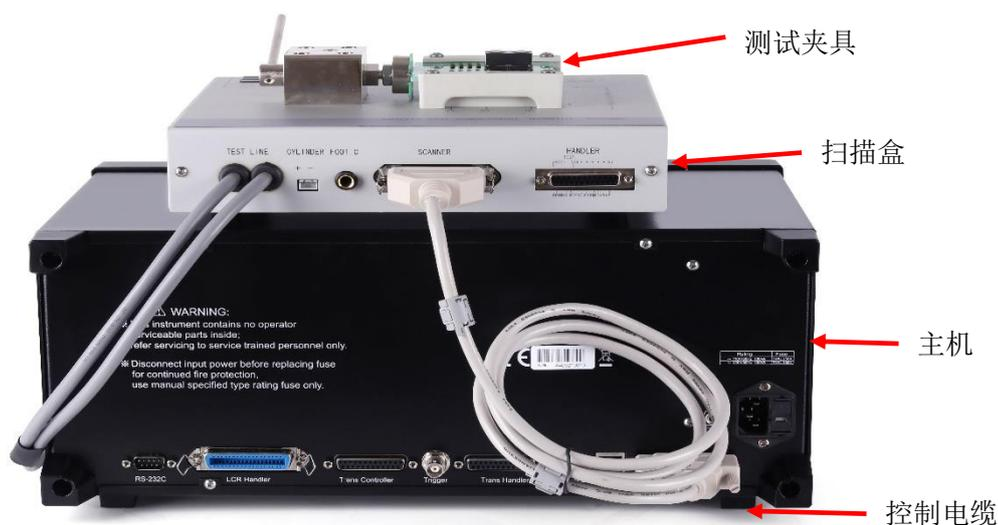
**注意：该控制线禁止带电插拔，禁止方向插反或插错接口。**
