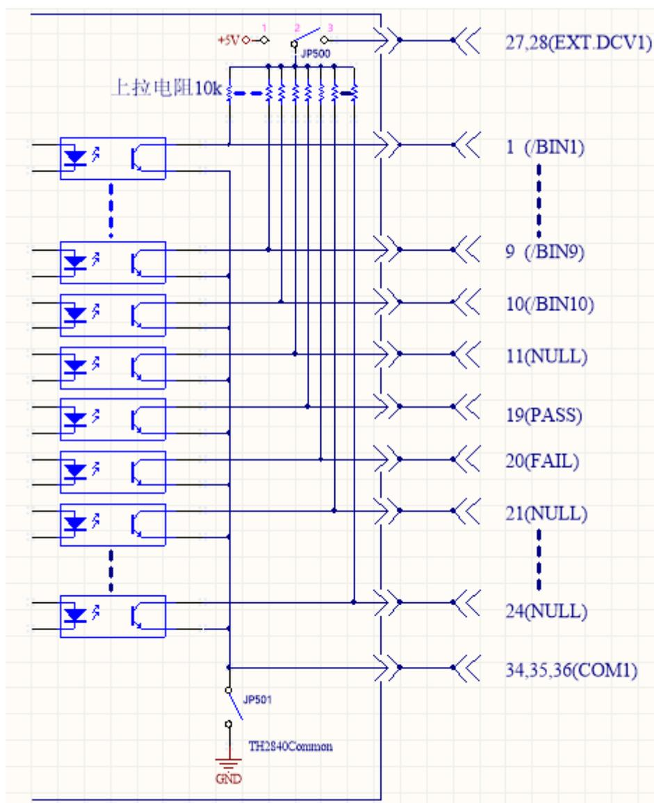
图 10-5 比较结果信号输出电路
