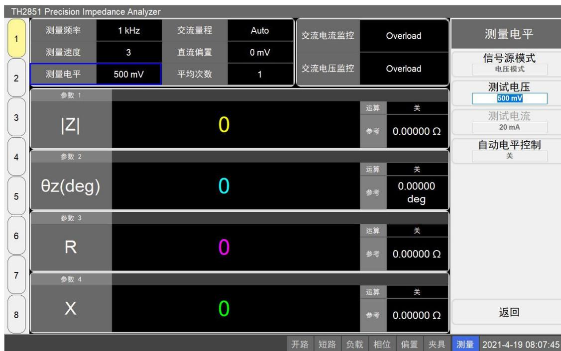
点击自动电平控制，可以进行自动电平控制（ALC）设置：
