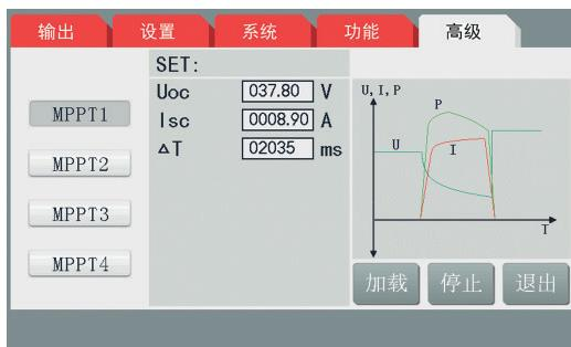
2. MPPT2：快速查找最大功率点，查找到后根据设置值实时追踪最大功率点
