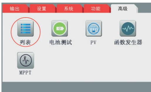
列表测试支持源/载电压、源电流、载电流及时间设置，最多可设置99组测试序列，测试序列可生成任意波文件供函数信号发生器调用。
