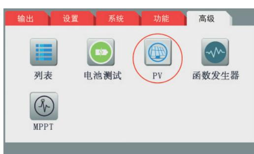
简易PV测试相对简单，仅需设置Uoc(开路电压)、Isc(短路电流)、Umpp(最大功率点的电压)以及Impp(最大功率点的电流)。
