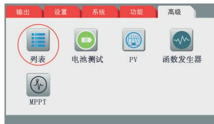
列表测试支持源/载电压、源电流、载电流及时间设置，最多可设置99组测试序列，测试序列可生成任意波文件供函数信号发生器调用。
