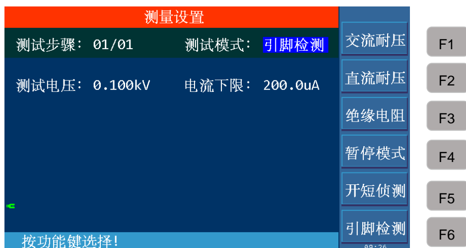
图 4-16 引脚检测设置
