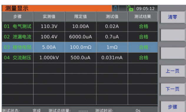
列表模式：同一屏显示所有步骤的测试结果、判断结果、总判断结果
