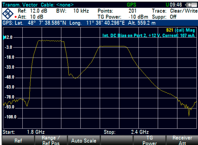
TMA 传输测量: 内置电源电压, 电流测量, 已连接 R&S®HA-Z240 GPS 接收机
