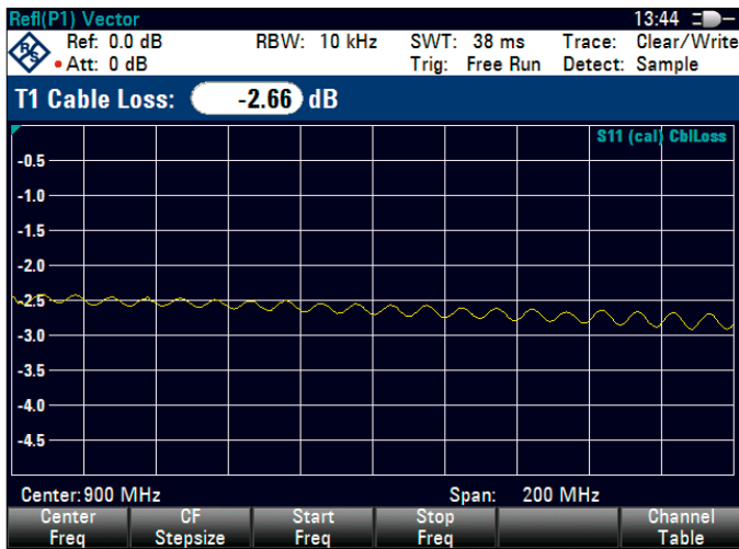
单端口电缆损耗测量
