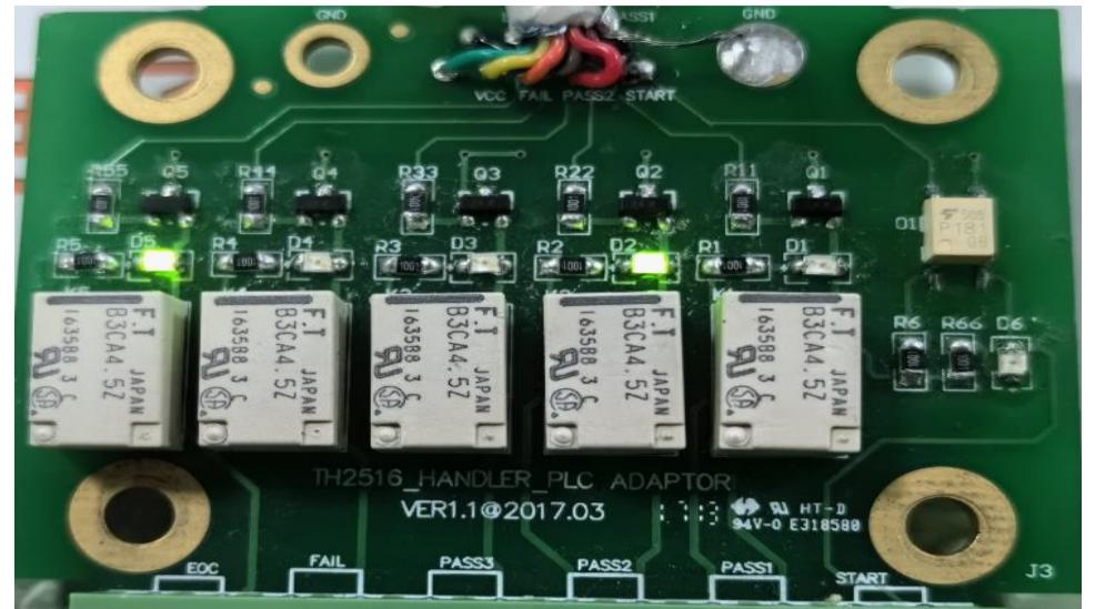
3) 档 3 分选结果合格, PASS3 输出低电平, PASS1、PASS2 输出高电平, 3 脚输出高电平
