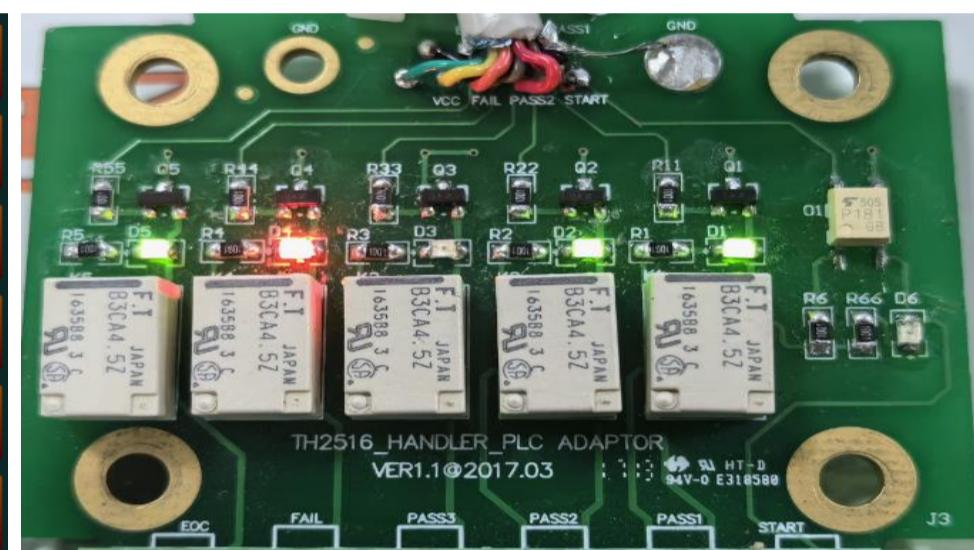
4) 分选结果都合格, PASS1、PASS2 、PASS3 输出低电平, 3 脚 (FAIL) 输出高电平
