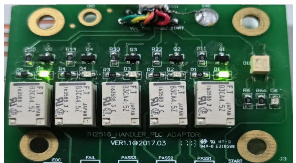
2) 档 2 分选结果合格, PASS2 输出低电平, PASS1、PASS3 输出高电平, 3 脚输出高电平
