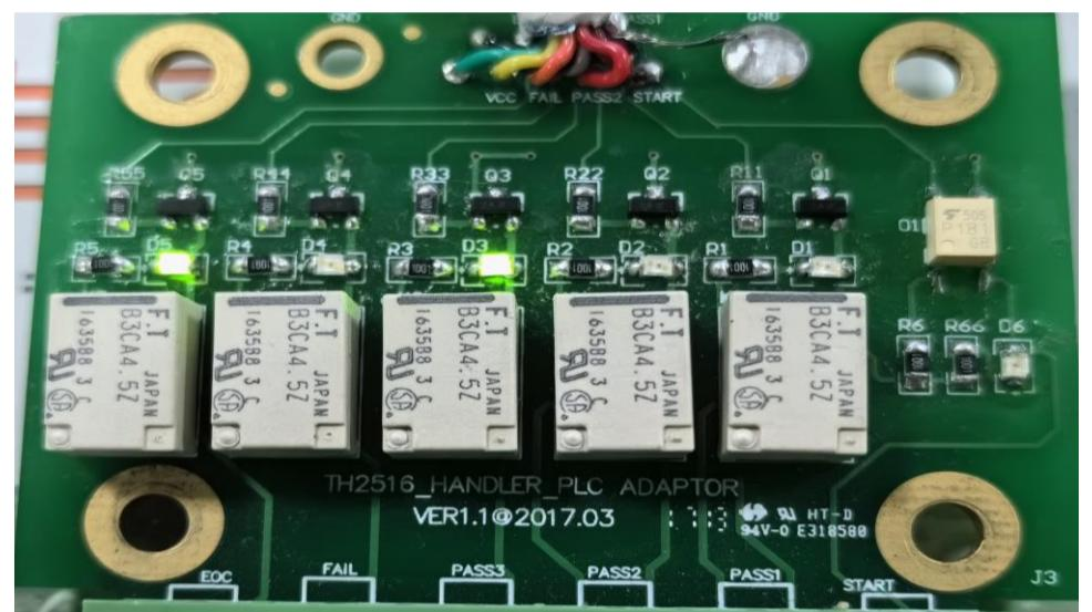
4) 分选结果都不合格, PASS1、PASS2、PASS3 输出高电平, 3 脚输出低电平
