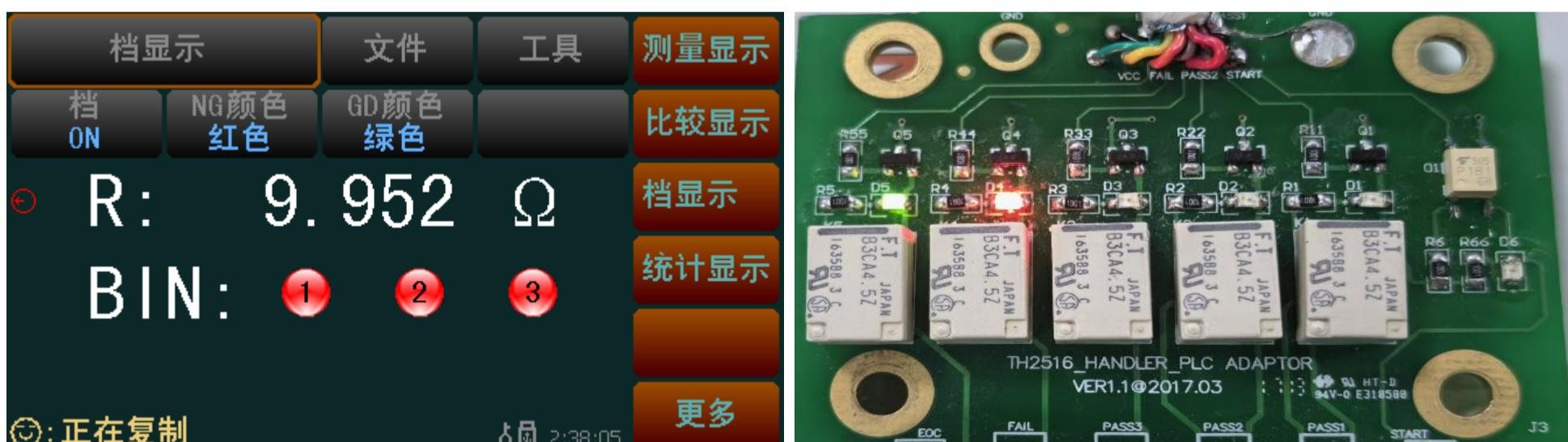
2) 档 1 分选结果合格, PASS1 输出低电平。PASS2、PASS3 输出高电平, 3 脚 (FAIL) 输出高电平
