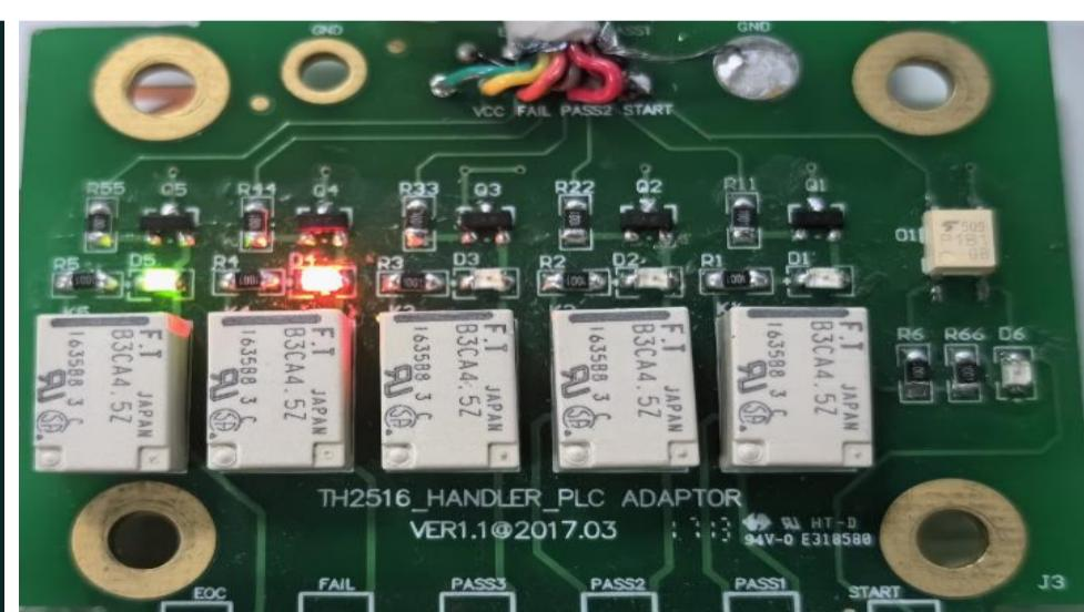
2) 档 1 分选结果合格, 6 脚 (PASS1) 输出低电平, PASS2、PASS3 输出高电平, 3 脚 (FAIL) 输出低电平
