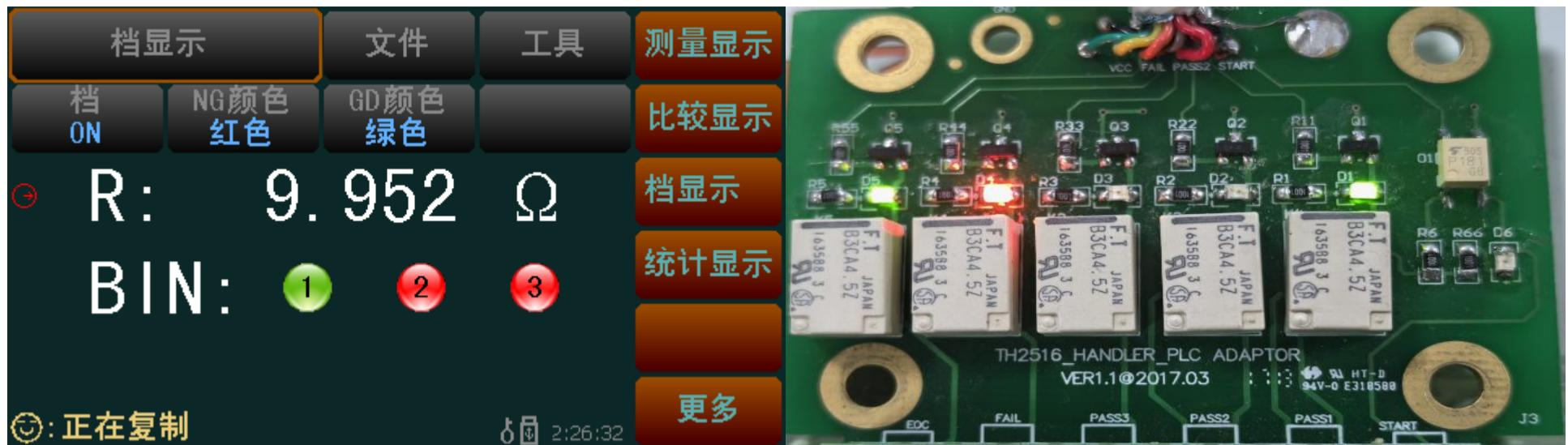
3) 档 1、档 2 分选结果合格, PASS1、PASS2 输出低电平, PASS3 输出高电平, 3 脚 (FAIL) 输出低电平
