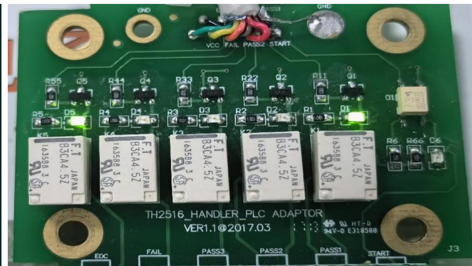
3) 档 1、档 2 分选结果合格, PASS1、PASS2 输出低电平, PASS3 输出高电平, 3 脚 (FAIL) 输出低电平
