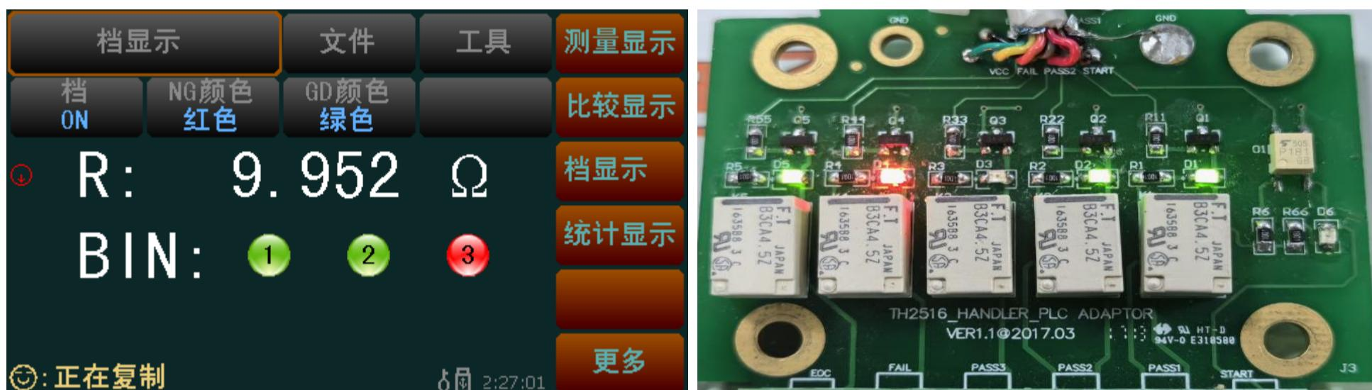
4) 分选结果都合格, PASS1、PASS2 、PASS3 输出低电平, 3 脚 (FAIL) 输出高电平
