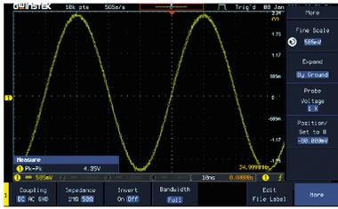
微调功能允许用户根据需要微调垂直刻度，以实现满刻度测量并提高电压或电流测量的精度。
