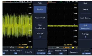
高分辨率的采样方式，有效地消除了噪声，提高了自动测量的精度。
