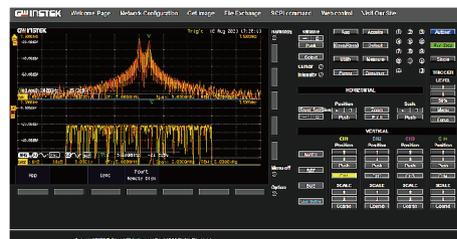
GDS-3000A 具有内置的 Web 服务器功能, 允许用户通过网口连接使用同一网络中的浏览器连接 GDS-3000A 的 Web 服务器。可以获取系统信息, 并且可以远程观察和捕获示波器屏幕 (.png 文件)。
