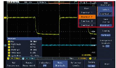
GDS-3000A 系列提供了 38 个测量项目。根据电压、电流、时间、频率和延迟测量等参数，用户可以决定选择哪些测量项目。在单个显示屏上，GDS-3000A 系列提供 8 个测量参数选择。
