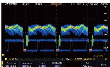
在波形显示技术方面，GDS-3000A 系列示波器能够显示 RGB 颜色梯度，每个梯度 8 位，能够描绘出深刻的梯度波动；重新创建模拟示波器的显示功能。当输入复合信号时，GDS-3000A 系列能够精确显示彩色猝发信号，并以亮度显示多层次的细节，用户可以轻松地确定和分析波形。
