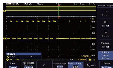
GDS-3000A 系列示波器具有强大且无与伦比的数据检索记录长度。200M 的超大记录长度允许用户在进行基本测量应用时轻松捕捉波形细节。
