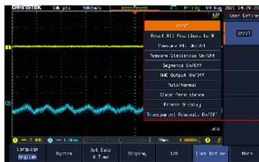
GDS-3000A 包含一个用户自定义键，允许用户根据测量要求设置用户定义的十个功能中的任意一个，包括 XY/YT；位置重置为 0；测量所有（开 / 关）；测量统计（开 / 关）；分段存储（开 / 关）；AWG 输出（开 / 关）；自动 / 正常；余晖清除；冻结显示和透明读数（开 / 关）。
