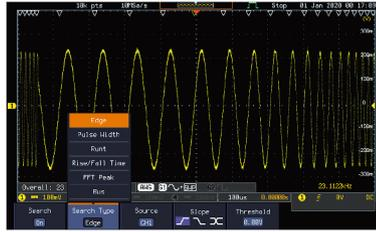
用户可以根据触发条件快速搜索所需波形。激活搜索功能后，空心倒三角形将显示满足触发条件的位置。左上角显示满足触发条件的波形总数。用户可以根据触发条件设置波形搜索，如边缘、脉冲宽度、矮波 Runt、上升 / 下降和总线。
