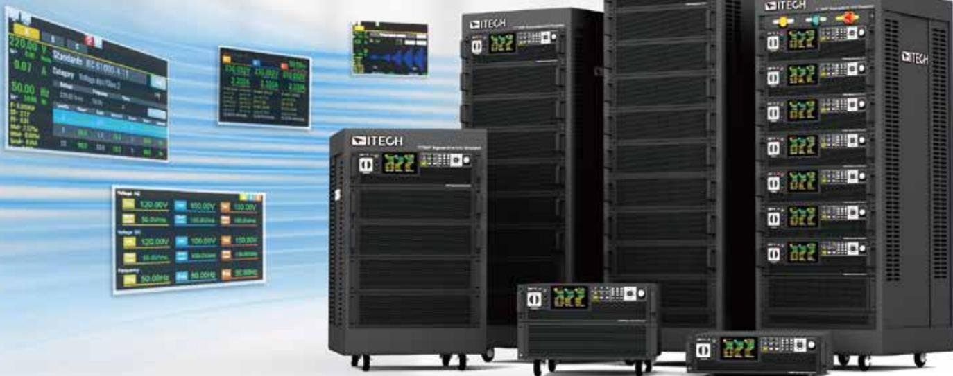
IT7900EP系列高性能回馈式电网模拟器提供用户领先的一体化测试解决方案, 全系列采用碳化硅(SiC)技术, 可以是一台大功率交流电源, 也可以作为电网模拟器和全四象限功率放大器使用, 同时也是一台回馈式的交/直流电子负载。全四象限运行, 高效的回馈能力可以将电能无污染的回馈电网, 满足环保需求的同时也节省了大量用电和散热成本。紧凑式、模块化、高效率的结构设计, 使IT7900EP可以在3U的体积内提供21kVA的功率, 主从并联更可扩展功率至1MVA以上。采用基于彩色触摸屏的用户界面, 可以直接定义不同波形, 丰富的操作模式满足用户单相, 三相, 反相的测试需求, 为测试提供了较高的灵活性, 可以广泛应用于光伏、储能系统、新能源汽车等多个领域。
