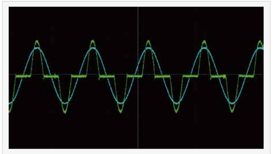
IT7900EP系列在交流模式下可以开启Rectified整流功能,使负载工作在第一和第三象限,电压和电流始终同向。此时,用户可以选择波形完整性,包括全波,正半波,负半波。
