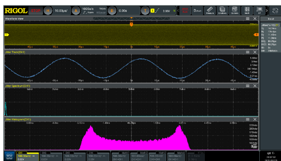
对带有抖动的时钟信号进行抖动TIE测量 并通过趋势图和直方图分析
