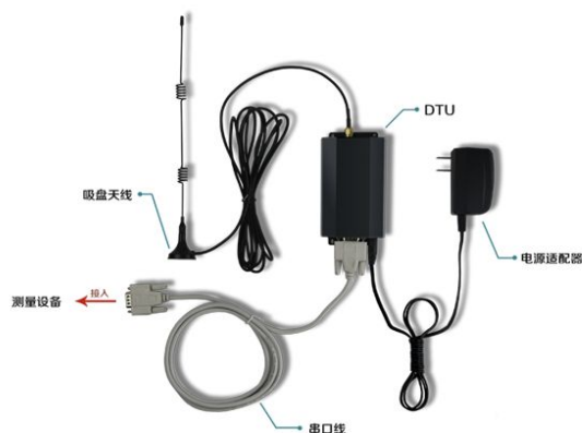
图 7-14 DTU-无线短信报警器
