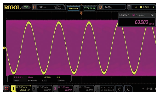
普通 1 M 点的软件测量已无法测出高频信号的准确频率
