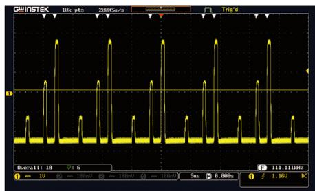
GDS-1000B 示波器可选配波形搜索功能。如图所示波形，在一串波形中，有高，中，低不同幅值的很多波形。针对这种大量的波形资料中，搜索感兴趣的波形对工程师来说非常困难。拥有波形搜索功能，可选择搜索种类以及设定搜索条件，符合条件的波形会全部被标记以及显示满足条件下的波形数量。用户可以快速浏览有兴趣的波形。
