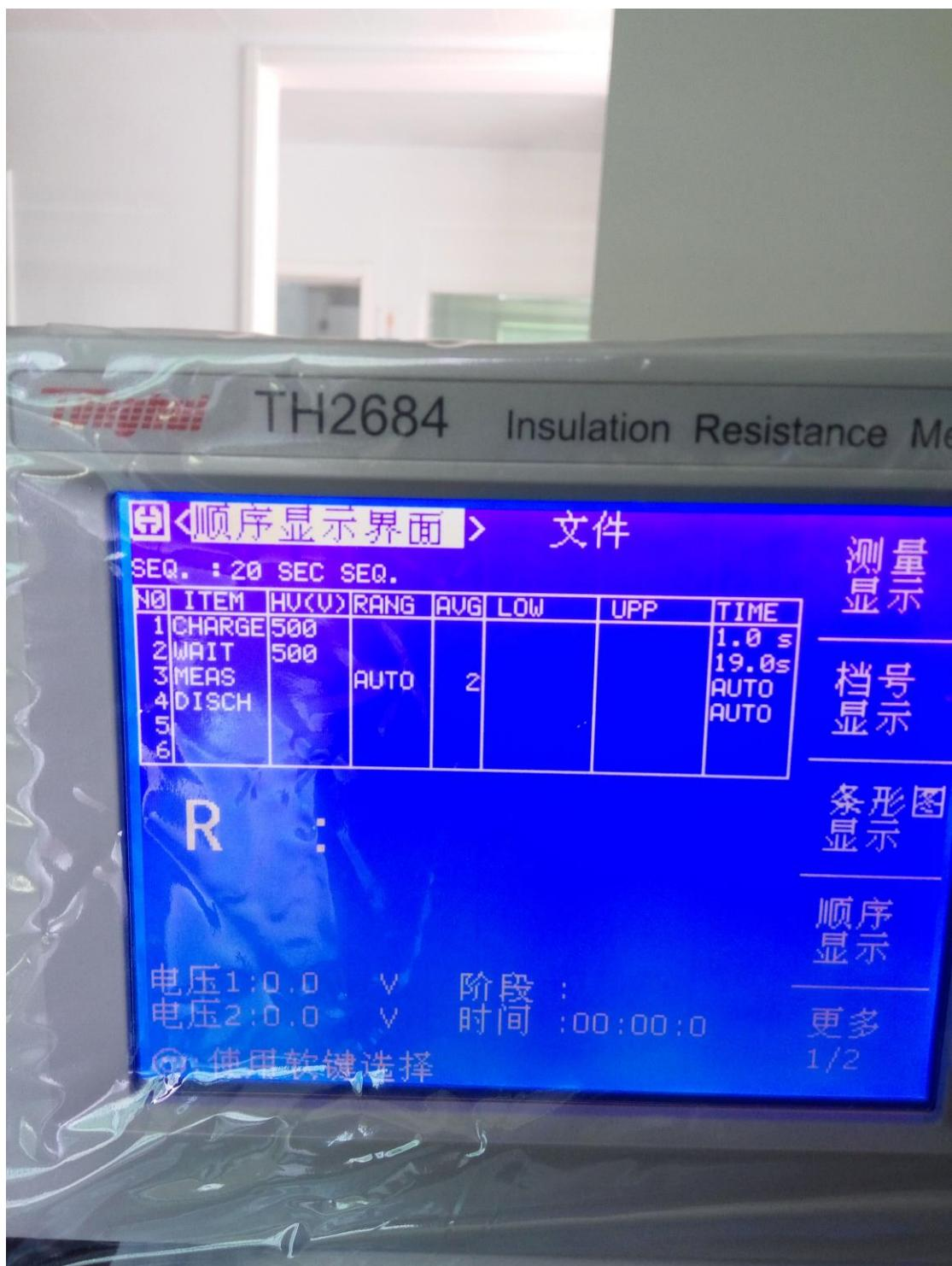
普通测试界面的测试只适合小电流要求的测试比如纯电阻等，电容类都不适合用普通测试方法，一定要用顺序测试页面哦。顺序测试设置也要大概预估电容的充电时间然后设置充电时间加等待时间等于总的大概充电时间。
